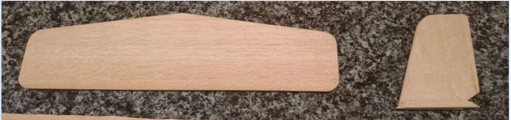
Fertig vorbereitetes Höhen- und Seitenleitwerk
